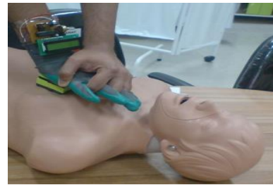
شکل ۱. نحوه قرار گیری سیستم طراحی شده بر روی مولاژ و انجام آزمایش
